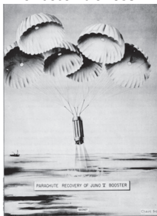
Fig 5 : récupération du 1 er étage de Juno-V.
