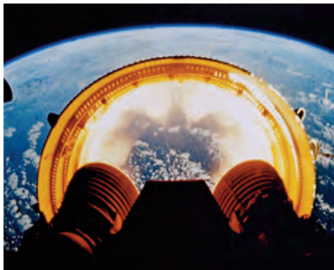
Figure 4 – Séparation de l'interétage S-1C/S-II pendant le vol de l'AS-502
