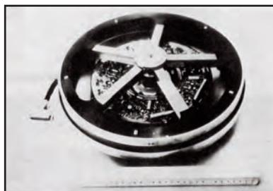
Figure 6 – Le volant d'inertie réalisé par Teldix (Allemagne).
