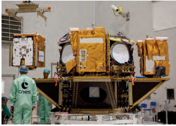
Pose des quatre microsattellites de la constellation Elisa- complémentaire à la constellation Essaim - présentée en page 42 de la publication n°45.
