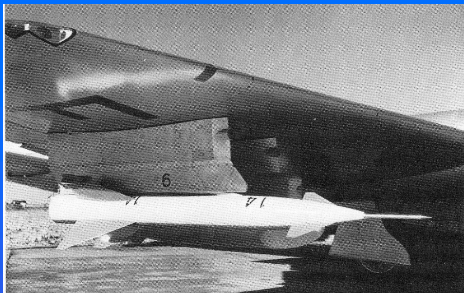
5.51 MATRA R.051 (AA 20) guidage ECA, MATRA, SFENA, Turck autodirecteur Drivomatic, Thomson 10.54 1 è interception fr
