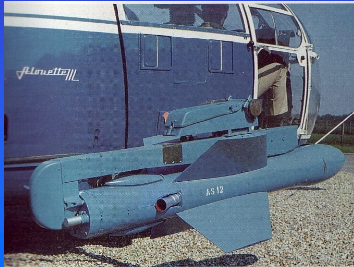
10.4.59 Nord SS 12 Achille 150 daN+ Hermione 400 daN 75 kg - 335 km/h - 6 km 6.010F (5 pays)
