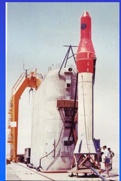
18.5.65 VE 111LG v L2 3,7 t - M3,2? - h = 130 km 1 er guid inertiel Fr (SAGEM E22B) 2L
