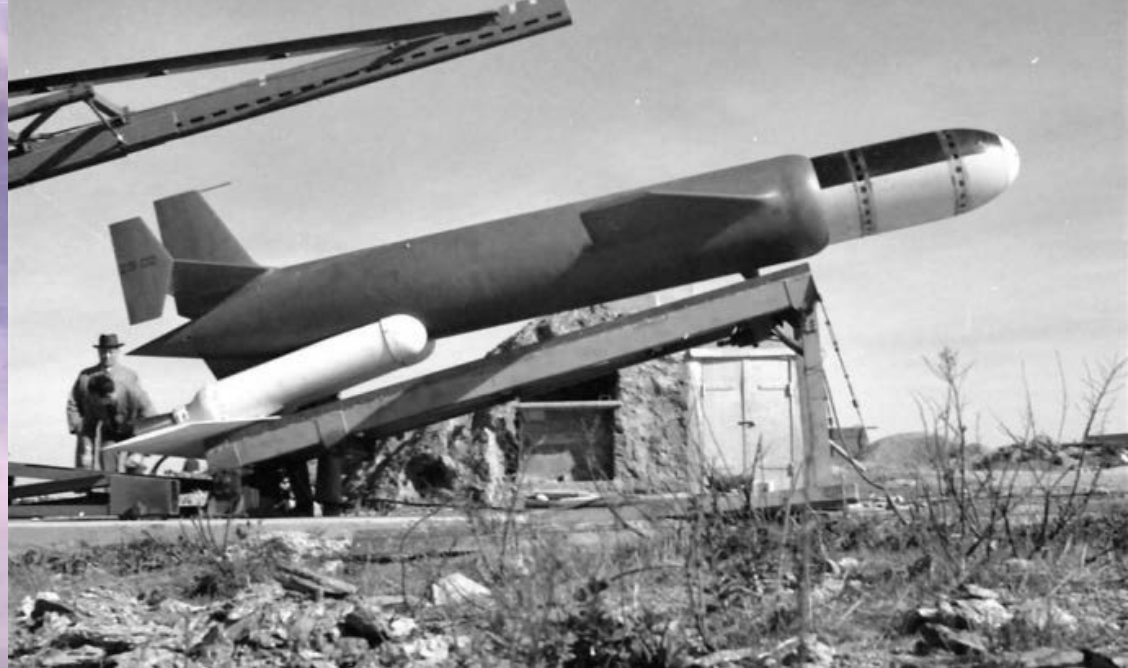
2.58 Laté 231 Malafon 2 Vénus radioguidé 1.450 kg - 750 km/h - d = 15 km 400L
