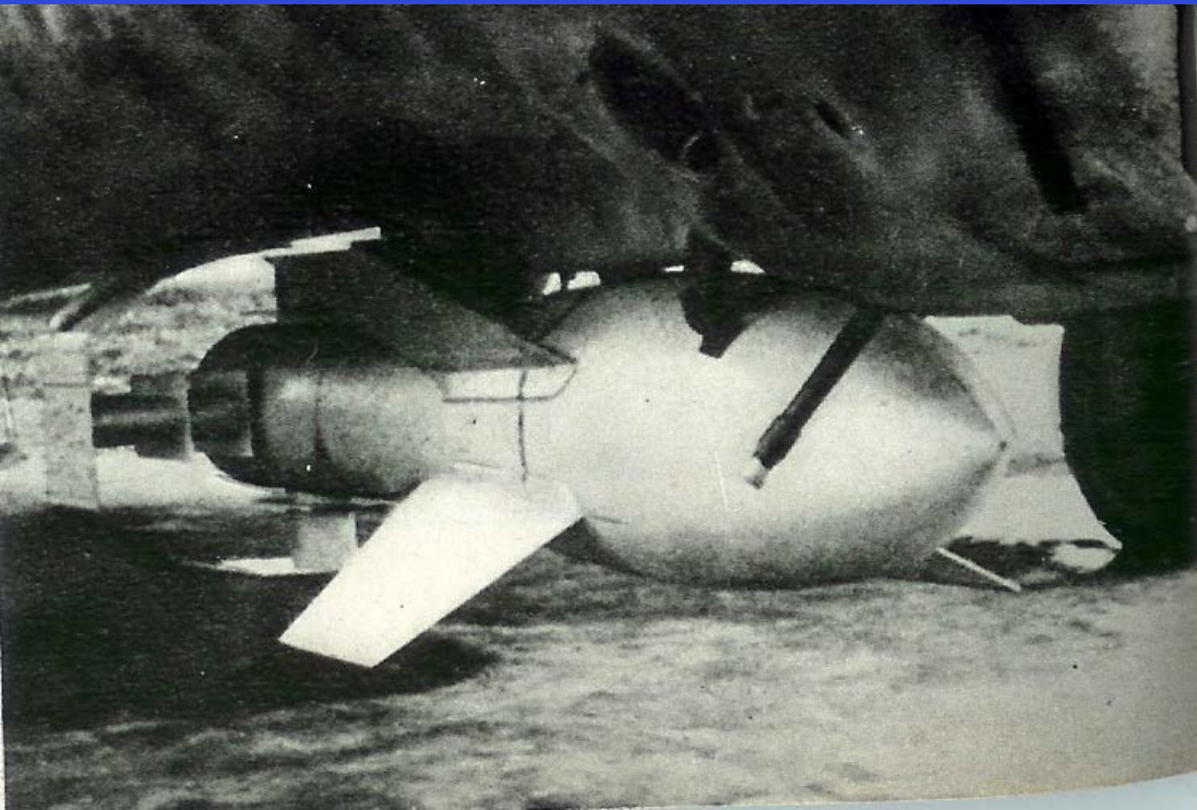
20.8.47 Pluvier (FX 1400) filoguidé 1.570 kg - 280 m/s >36 ex
