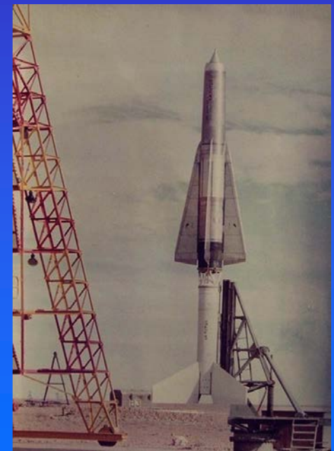
10.59 Nord Vega (SA) stato 630 daN PA M4,2 - h = 33 km - d = 200 km 18F, 17L
