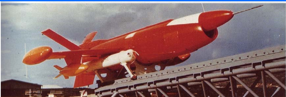
1.55 N 5510 (CT 20) Marboré VI 480 daN radioguidé 1.100 kg - 950 km/h - 250 km
