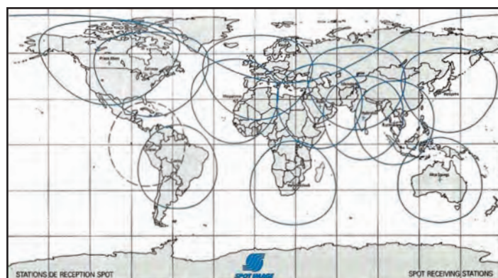
Figure 14 : cercles d'acquisition de la télémessure image par les stations de réception directe SPOT à la fin de 1990
