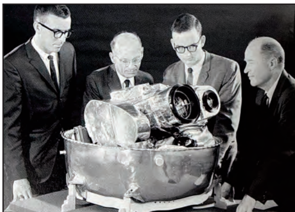
Fig 3 : Système photographique Lunar Orbiter.
